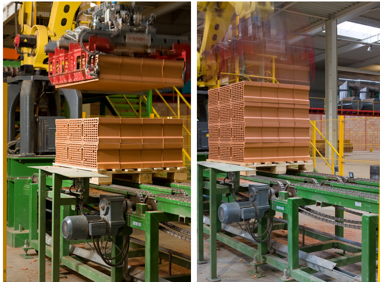
fig. 2: Bratul robotului asezand caramizile fasonate pentru procesul de uscare
