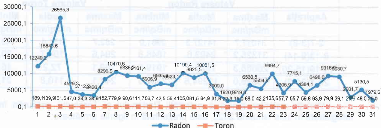
Variația valorilor zilnice a Radonului și Toronului, aspirația 14-19 (15-20), în luna Ianuarie 2023 [mBq/mc]
