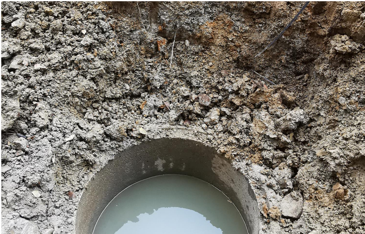
Fig.21.Stagnosoluri cu un pregnant exces de umiditate în trogul (spațiul dintre două valuri ale unei alunecări de teren ample) unde se află și baza proprietății analizate (locatia unde va fi realizată clădirea pentru locuit). Aceste soluri favorizează instalarea aici a speciilor de arbori higrofilii din genul Salix și apar din cauza acumulării de apă în spațiile microdepressionare din trog ca și datorită substratului geologic impermeabil al arșilelor cenușii din Formațiunea de Chechiș.
